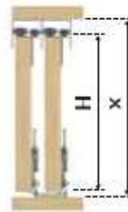
Las medidas de alto y ancho del armario deben medirse en el interior del hueco luz del armario.
